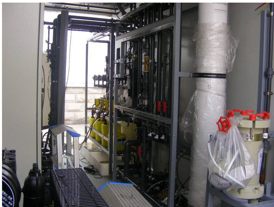
Figura 8 - Piloto de ultrafiltração de propriedade da DuPont instalado em container
